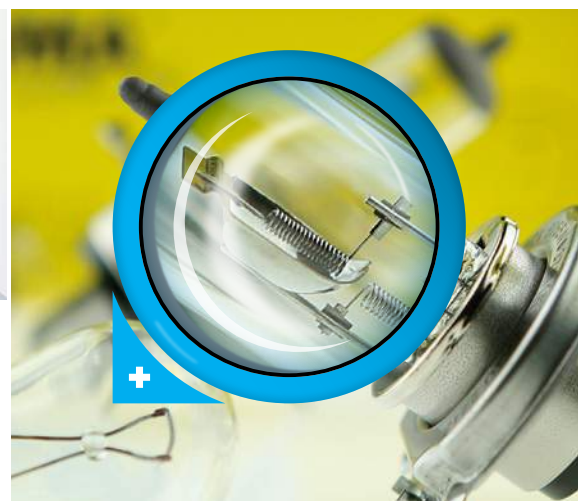
Wytrzymała skrętka żarnika wykonana z wolframu, osadzona na molibdenowych wspornikach bez trudu przenosi szerokie pasmo częstotliwości wibracji.
