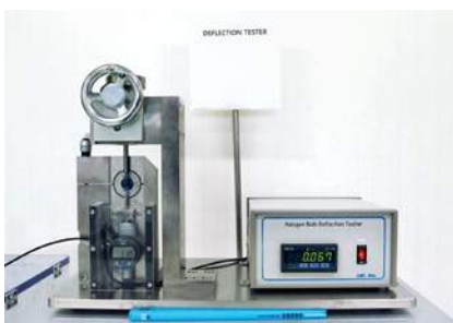
Testy na wytrzymałość mechaniczną potwierdzają użycie wysokiej klasy materiałów, zarówno części szklanej jak i trzonka.
